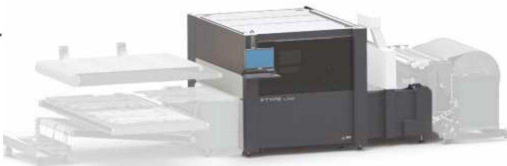
**H-Type Conveyor** è il sistema laser professionale per il taglio di tessuti naturali e tecnici in rotolo anche colorati e stampati con una larghezza massima di 1000 mm.
